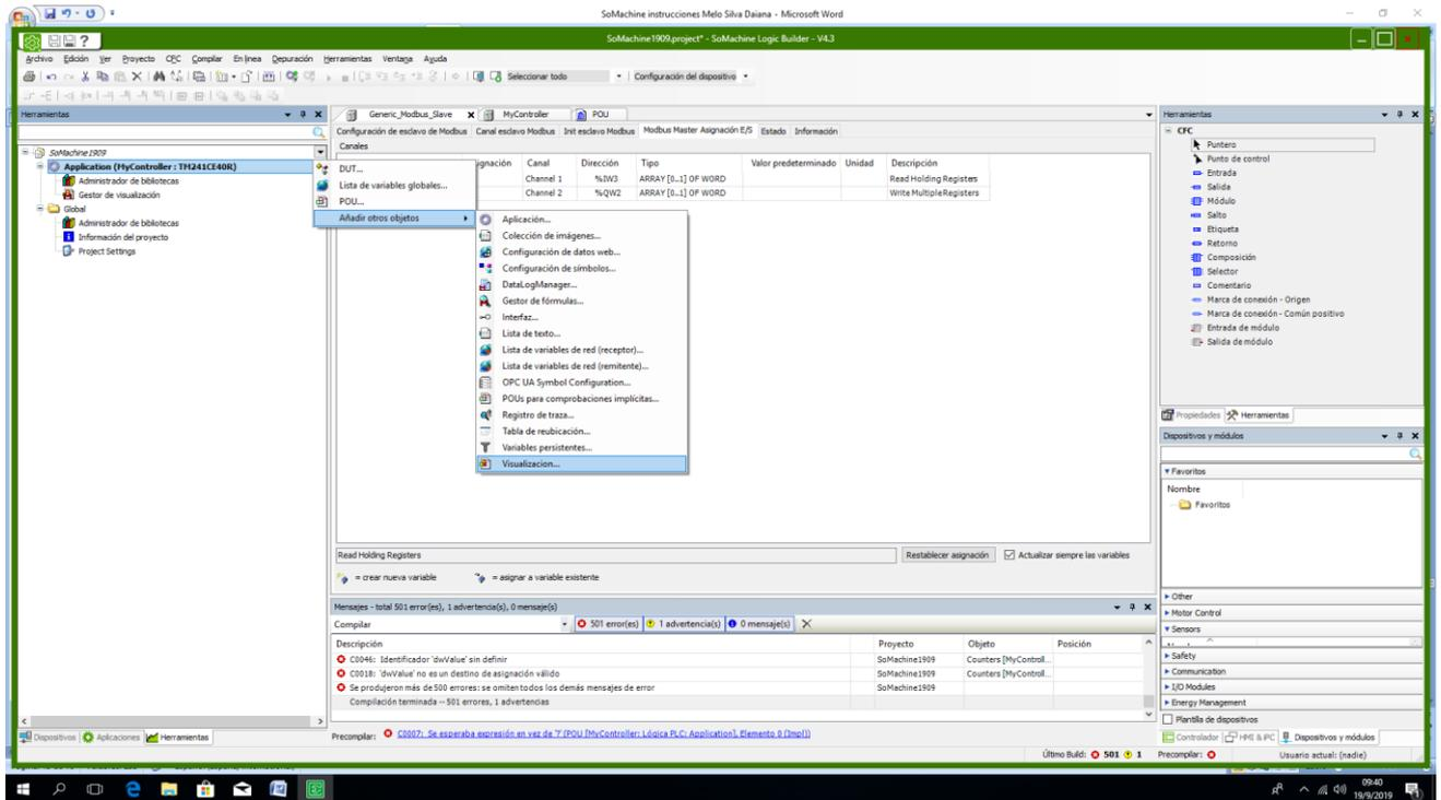
Una vez agregado el visualizador seleccionamos “Marco” de la barra de herramientas del lateral derecho de la pantalla y arrastramos al centro de la estaña de visualización
